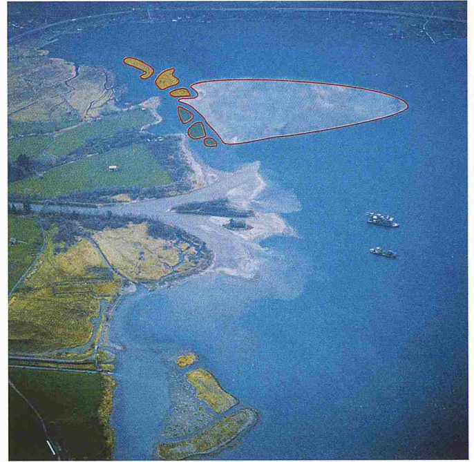
Mit Ausbruchmaterial aus dem Tunnelbau entsteht im Urnersee eine naturnahe Flachwasserzone. Auf dem rechten Bild sind die Inseln eingezeichnet, die links der Reussmündung aufgeschüttet werden
