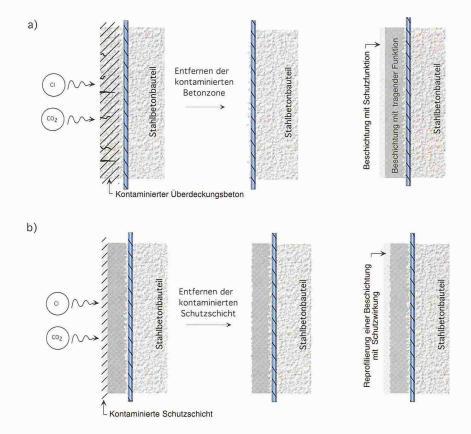
Konzept der Trennung der Aufgaben für ein neues Stahlbetonbauwerk
