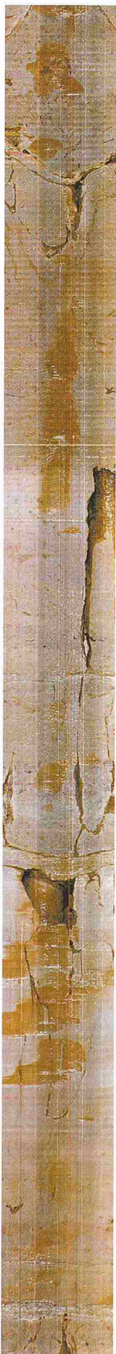
1 Die digitale Aufnahme einer Bohrlochwand in einem Kalkstein. In der Bildmitte schneidet eine fast senkrecht stehende Störung das Bohrloch
