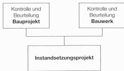
Die Kontrolle und Beurteilung des Bauprojekts umfasst die Berechnung, Bemessung und Konstruktion sowie die zugehörigen Baupläne. Es handelt sich dabei um rein statisch-konstruktive Probleme, wobei sich aufgrund der Plankontrolle bereits viele schadenanfällige Stellen lokalisieren lassen.
