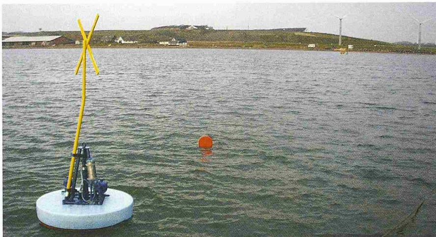
1:10-Modell des Point Absorber beim Test in der Nordsee (Bild: Kim Nielsen/Ramboll)
