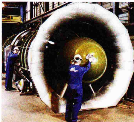
Die Wells-Turbine (Bild: Wavegen)
