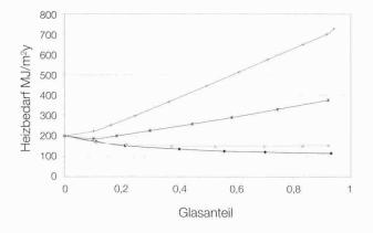
Der Heizenergiebedarf eines Raumes in Funktion des Verglasungsanteils. Zürich, Südseite, nichttransparente Teile:  $U = 0.3 \text{ W/m}^2\text{K}$ , Luftwechsel  $n = 0.3 \text{ h}^{-1}$ . WS: Wärmeschutzverglasung  $U = 0.7 \text{ respektive } 1.3 \text{ W/m}^2\text{K}$ , 2f-IV: Isolierverglasung, Einfach: Einfachverglasung
