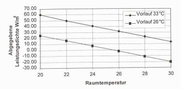
8 Abhängigkeit der abgegebenen Heizleistung von der Raumtemperatur für zwei verschiedene Vorlauftemperaturen
