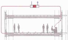
Nutzung der Speichermasse: Die Decken des Gebäudes sind aus Beton und bleiben unverkleidet. Dadurch kann das Speichervolumen der Primärkonstruktion der Jahreszeit entsprechend genutzt werden, um die Arbeitsräume vorzutemperieren
