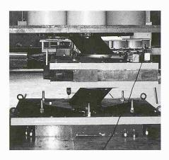
Verformung zweier Erdbebenlager beim statischen Bruchversuch
