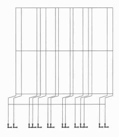
Erste Eigenform des sanierten Tanks mit einer Frequenz von 0,5 Hz
