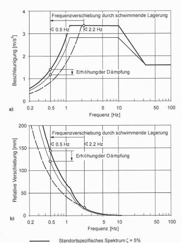
Bemessungs-Antwortspektren. a) Beschleunigungsspektren, b) Verschiebungsspektren
