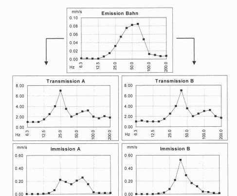
2 Von der Emission zur Immission, ein mögliches Beispiel: Unterschiedliches Ergebnis bei Verschiebung der Transmissionsfunktion um zwei Terzen: Die Immission wird mehr als verdoppelt
