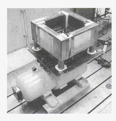
Biomasse-Stirlingmaschine mit vier Erhitzerköpfen zur Strahlungsaufnahme in einer quadratischen Brennkammer. Leistung der Maschine etwa 35 kW<sub>el</sub>. (Entwicklung: Technical University of Denmark; Bild: [3])
