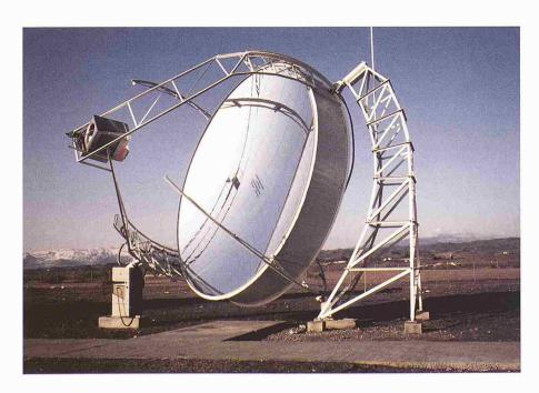
4 9 kW Dish/Stirling-Einheit auf der Plataforma Solar in Almeria, Spanien, Entwicklung [5] (Bild: Schlaich Bergermann und Partner)
