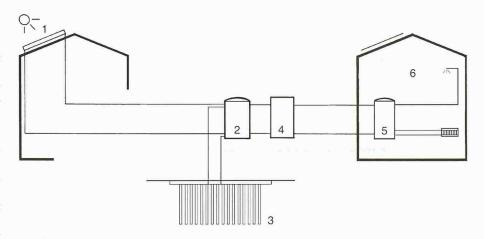
Saisonspeicheranlage mit Kollektoren und einem oberflächennahen Erdspeicher für eine Siedlung. Legende: 1 Kollektorfeld; 2 Pufferspeicher (Kurzzeitspeicher); 3 Erdspeicher/Diffusivspeicher (Saisonaler Speicher); 4 Ergänzender Wärmeerzeuger; 5 Wärmeübergabestation im Gebäude (für WW- und Heizung); 6 Verbraucher
