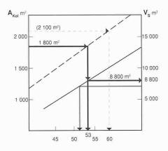
o Das Bild bezieht sich auf das Beispielszenario der Altbausiedlung Wettswil. Legende: «Anwendungfenster» saisonale Speicherung, Typsiedlung Altbau (QW,G =1006 MWh/a);  $A_{K_0 I}$  = Fläche Sonnenkollektoren;  $V_S$  = notwendiges Erdspeichervolumen; SF = solare Deckungsrate
