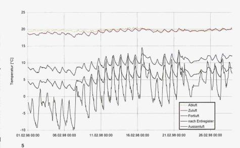
Messungen der Luft-Temperaturen: Deutlich sichtbar ist der grosse Temperaturhub des Erdregisters (Differenz «nach Erdregister» zu Aussenluft) sowie der Wärmerückgewinnung (Differenz Zuluft zu «nach Erdregister»)
