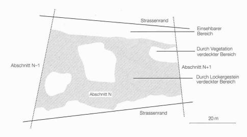
Schematische Darstellung der einsehbaren und verdeckten Bereiche im Abschnitt N ober- und unterhalb der Bristenstrasse
