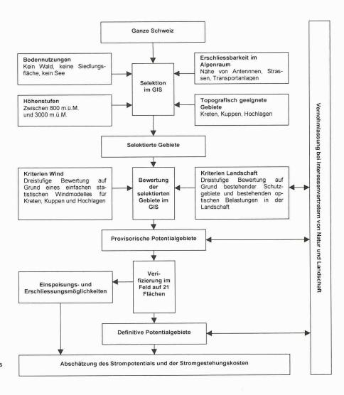
Vorgehen für die Ermittlung des Strompotentials aus Windkraftanlagen in der Schweiz
