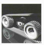
oder auf kundenspezifische Längen endlos verschweisst lieferbar. Die Brecoflex-Zahnriemen mit Bogenverzahnung werden dagegen ohne Zugstrangunterbrechnung endlos gefertigt und sind in Längen von 1500 mm bis zu maximaler Fertigungslänge von 22 000 mm in Abstufungen von je 100 mm erhältlich. Angst + Pfister AG
