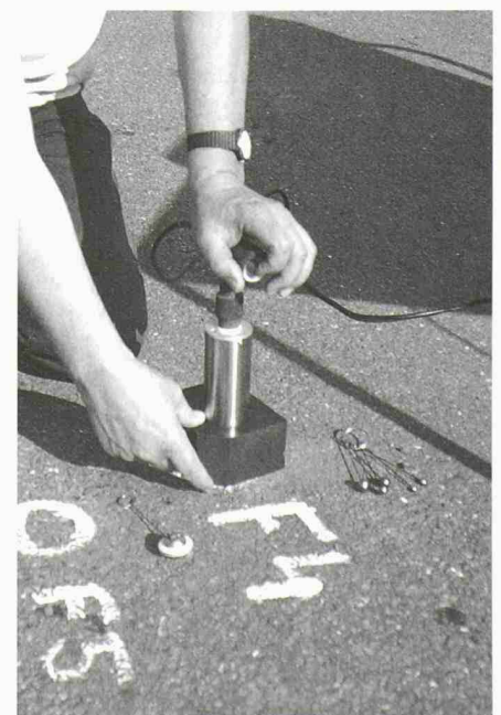
7 (rechts) Impact-Echo-Messgerät in der praktischen Anwendung
