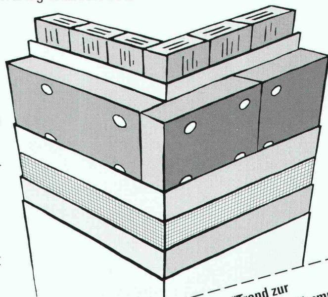
Und damit Sie auch von der Baustelle nur Gutes hören, gibt es die neue FLUMROC-Dämmplatte mit Wellfaserstruktur, harter Deckschicht und der speziellen Beschichtung für die optimale Putzhaftung.
