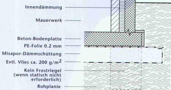
Anstelle eines klassischen Frostriegels kann unter eine Bodenplatte auch einfach Misapor® eingebracht und verdichtet werden. Ein seitlicher Überhang von 30-50 cm Misapor® genügen und schon übernimmt der einfache Schaumglasschotter die Funktion eines aufwendigen Frostriegels. So erspart Ihnen Misapor® Aushub, Armierung, Beton, Frust und vor allem Frost.
