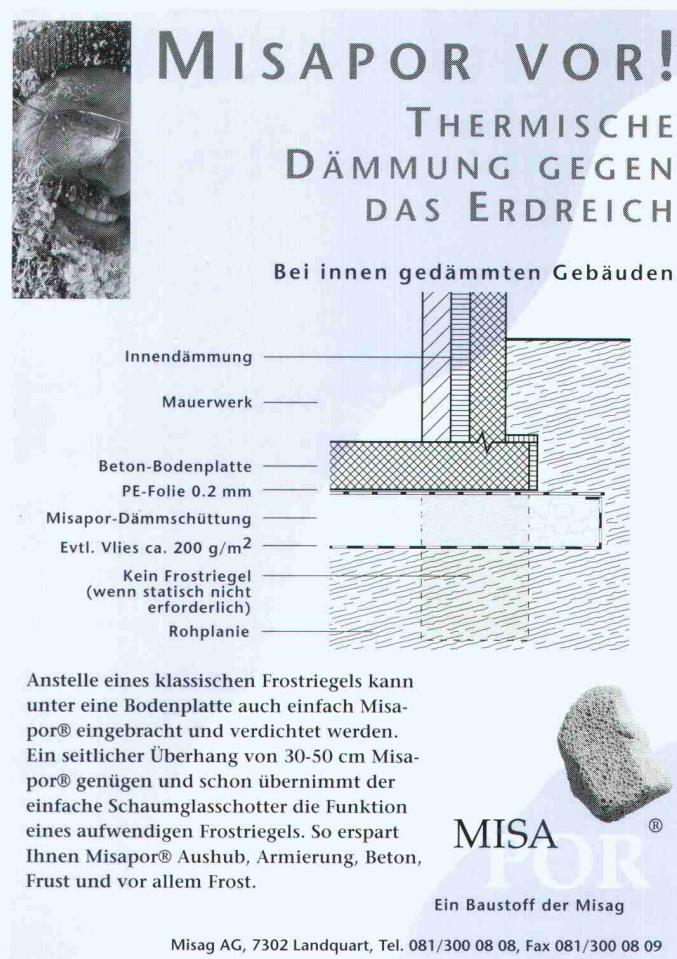
Anstelle eines klassischen Frostriegels kann unter eine Bodenplatte auch einfach Misapor® eingebracht und verdichtet werden. Ein seitlicher Überhang von 30-50 cm Misapor® genügen und schon übernimmt der einfache Schaumglasschotter die Funktion eines aufwendigen Frostriegels. So erspart Ihnen Misapor® Aushub, Armierung, Beton, Frust und vor allem Frost.
