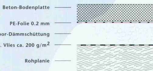
Aushub raus, Misapor® rein, PE-Folie drüber, Haus drauf! Im Detail: Mit Lastwagen, Big Bags oder Kran Misapor® direkt auf die Rohplanie entleeren. Nichts anpassen, nichts zuschneiden. Mit einer Walze oder einem Plattenvibrator Misapor® um Faktor 1.3 verdichten. Eine abschliessende PE-Folie verhindert das Eindringen der Zementmilch – und schon kann weitergebaut werden. Einfachere Verarbeitung = kürzere Bauzeit = kleinere Kosten. So einfach ist das.
