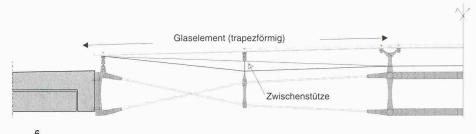
Verformung des Seilwerks unter Last
