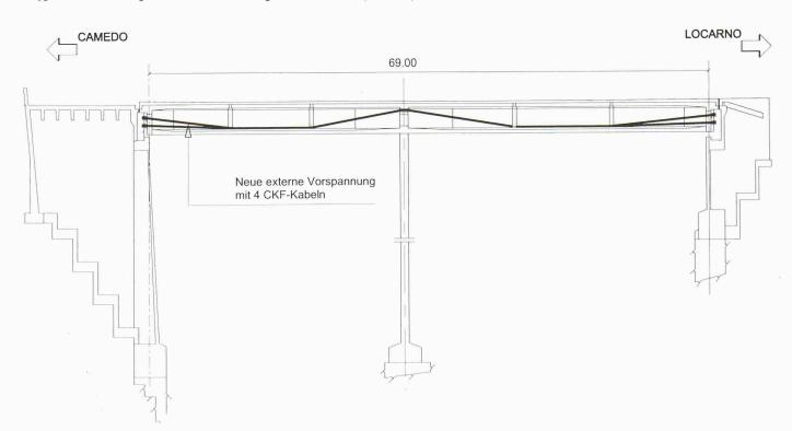
den Vorteilen vor allem hinsichtlich Montage ergeben sich auch in konstruktiver Hinsicht neue Möglichkeiten (kleinere Umlenkvorrichtungen usw.).
