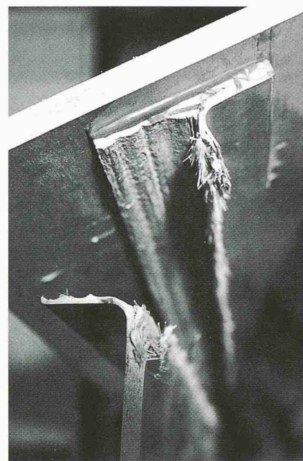
Bruch im Profil, Klebestelle intakt
