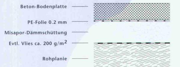
Aushub raus, Misapor® rein, PE-Folie drüber, Haus drauf! Im Detail: Mit Lastwagen, Big Bags oder Kran Misapor® direkt auf die Rohplanie entleeren. Nichts anpassen, nichts zuschneiden. Mit einer Walze oder einem Plattenvibrator Misapor® um Faktor 1.3 verdichten. Eine abschliessende PE-Folie verhindert das Eindringen der Zementmilch – und schon kann weitergebaut werden. Einfachere Verarbeitung = kürzere Bauzeit = kleinere Kosten. So einfach ist das.
