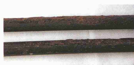
Starker Lochfrass an zwei Spanndrähten
