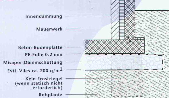
Anstelle eines klassischen Frostriegels kann unter eine Bodenplatte auch einfach Misapor® eingebracht und verdichtet werden. Ein seitlicher Überhang von 30-50 cm Misapor® genügen und schon übernimmt der einfache Schaumglasschotter die Funktion eines aufwendigen Frostriegels. So erspart Ihnen Misapor® Aushub, Armierung, Beton, Frust und vor allem Frost.
