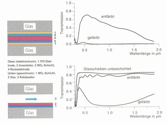
Schichtaufbau und Transmission elektrochromer (oben) und gasochromer (unten) schaltender Fenster. Als transparente Elektrode (TE) werden hochdotierte Halbleiter aufgebracht. Die Gegenelektrode (GE) ist meist ein geeignetes Übergangsmetalloxid
