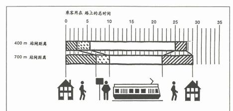
一段中等长(4公里)的路程上出行总时间比较。有轨电车(或公共汽车)的不同的站间距离 站间距离短的有轨电车和公共汽车的行驶速度低于站间距离长的。然而站间距离短,乘客用在 路上的总时间还是更少,因为这样上下车的步行路程短,从而使乘客大量赢得时间(并且方 便)。
