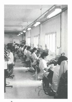
Arbeiterinnen bei der Bestückung von Elektronikkomponenten. Die Handarbeit ergibt einen deutlich geringeren Ausschuss als bereits realisierte Versuche mit Roboteranlagen
