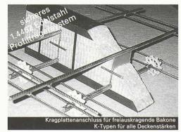
Der BASYCON-Anschluss weist ausgezeichnete Wärmedämmwerte (k<sub>lin</sub> unter 0,25 W/mK) auf, besteht komplett aus nichtrostendem Edelstahl 1.4462 und ist symmetrisch. Temperaturzwängungen sind im statischen Modell vollständig mitberücksichtigt und das steife Profilträgersystem erreicht in Bruchversuchen 70% höhere Lasten als rechnerisch ermittelt!
