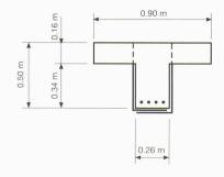
Träger T1 mit Anordnung der CFK-Winkel, (I/h = 12:1,  $\rho$  = 0,5%, a/d = 3,6, b/b<sub>o</sub> = 3,5), oben Längs- und links Querschnitt
