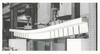
Träger T1 nach Versuch, ein Ablösen der CFK-Winkel vom Beton trat nur örtlich und vereinzelt auf
