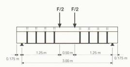
Träger T3 mit Anordnung der CFK-Winkel, (I/h = 12:1,  $\rho$  = 0,6%, a/d = 4,0, b/b $_0$  = 6,0), oben Längs- und unten Querschnitt
