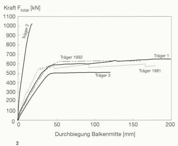
Kraft-Durchbiegungs-Diagramm der Versuche, Empa-Balken 1981: Empa-Bericht Nr. 206; Nachträgliche Schubverstärkung mit Stahllaschen, Empa-Balken 1992: Empa-Prüfbericht Nr. 127 773; Konventionelle Schubbewehrung
