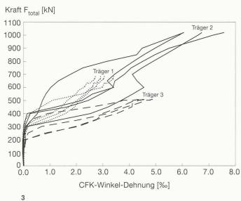
Kraft-Dehnungs-Diagramm der Versuche (Dehnung der CFK-Winkel in Stegmitte)
