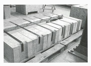
Prüfkörper und Winkel vor dem Zugversuch (Bild: Empa)
