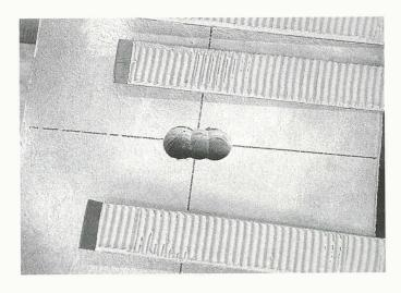
Prüfkörper vor dem Einkleben der CFK-Winkel (Bild: Empa)
