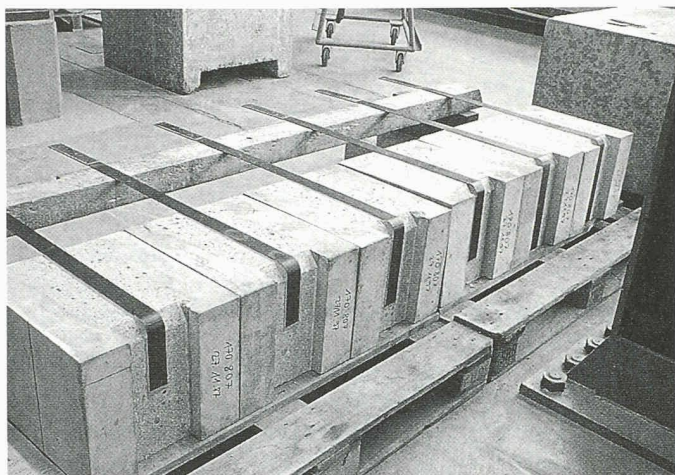
6 Prüfkörper und Winkel vor dem Zugversuch (Bild: Empa)
