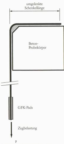
Zugversuch Umlenkzone, schematisch
