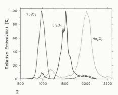
Emissionsspektren von drei für die Thermophotovoltaik geeigneten Emittermaterialien (von links): Ytterbiumoxid, Erbiumoxid und Holmium-
