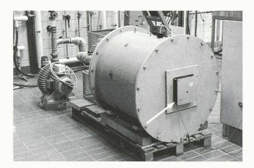
5 Prüfstand mit montiertem Radialkleinventilator
