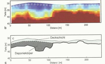
Tomografische Tiefenschnitte im Gebiet einer Altlast, berechnet aus refraktionsseismischen Daten. Die Schnitte zeigen die ungestörte Struktur ausserhalb (a) und (b) teilweise innerhalb der Deponie (0 bis 120 m). Eine Interpretation des in (b) gezeigten Tomogramms ist in (c) abgebildet
