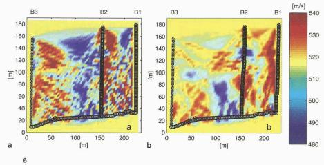
Tomographische Rekonstruktionen der in Bild 5 dargestellten Felder. a: Standard-Tomographie, b: Verbesserte Tomographie mit Berücksichtung der Koordinatenabweichungen
