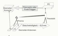
Automatische Positionierung am Beispiel eines Georadar-Messgeräts
