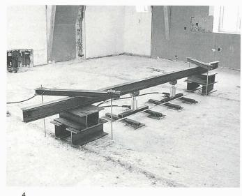
Seminar Unterstrass: Belastungseinrichtung mit hydraulischen Zylindern und lastverteilenden Sekundärträgern sowie den Stahlplatten mit Gipsoder Filzunterlage je nach vorhandener Bodenunebenheit. Der Abstand der Lastpunkte beträgt 0,45 m in der Quer- und 0,50 m in der Längsrichtung
