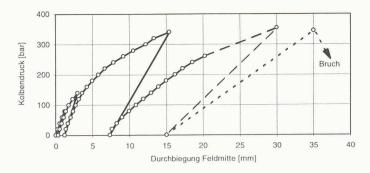
Seminar Unterstrass: Belastungs-Bruch-Versuche. Die gestrichelten bzw. gepunkteten Diagrammbereiche konnten nicht mehr mit der üblichen Genauigkeit erfasst werden, die ausgewiesenen Deformationswerte dürften aber zumindest in der Grössenordnung richtig sein
