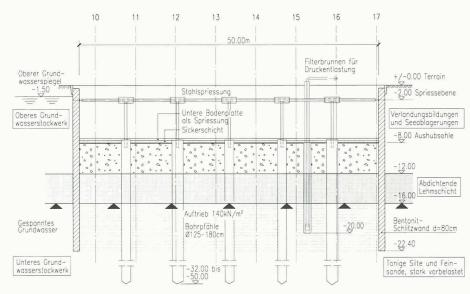
Schnitt durch Baugrube des Konzerthauses
