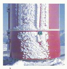
Vergleich des Eiswachstums auf PTFE (Teflon) und glasfaserverstärktem Polyester (GFK). Zwischen den hellbraunen, über den Umfang laufenden Klebebändern ist eine PTFE-Folie aufgespannt. Es ist kein Unterschied des Eisansatzes auf der PTFE-Folie und dem GFK (unteres Bilddrittel) ersichtlich. Gut zu sehen ist die starke Vereisung des Blitzableiters, der in der Mitte des Zylinders von oben nach unten verläuft
