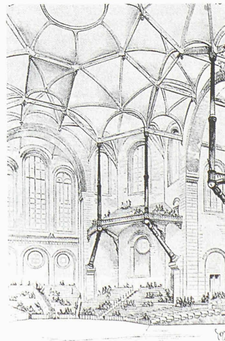
Saal mit Gewölberippen aus Eisen und Kappen aus Mauerwerk. Viollet-le-Duc, 1864. Aus «Entretiens sur l'architecture»
