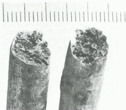
Gebrochene Bügel mit der für Spannungsrisskorrosion typischen spröden Bruchfläche
