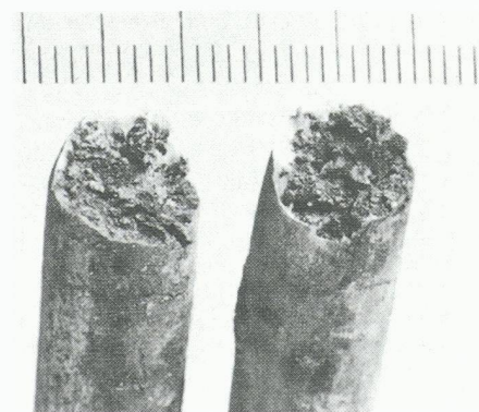
5 Gebrochene Bügel mit der für Spannungsrissskorrosion typischen spröden Bruchfläche
