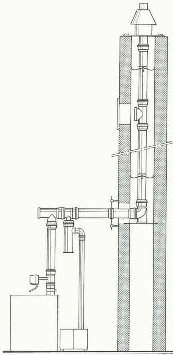
Die HAKA.GERODUR Abgasanlage 120° C aus PPs und die HSH Abgasanlage 160° C aus PVDF:
