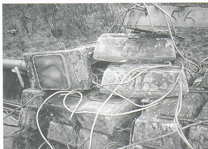
Ausgebaute Leuchten mit stark korrodierten Gehäusen aus Aludruckguss
