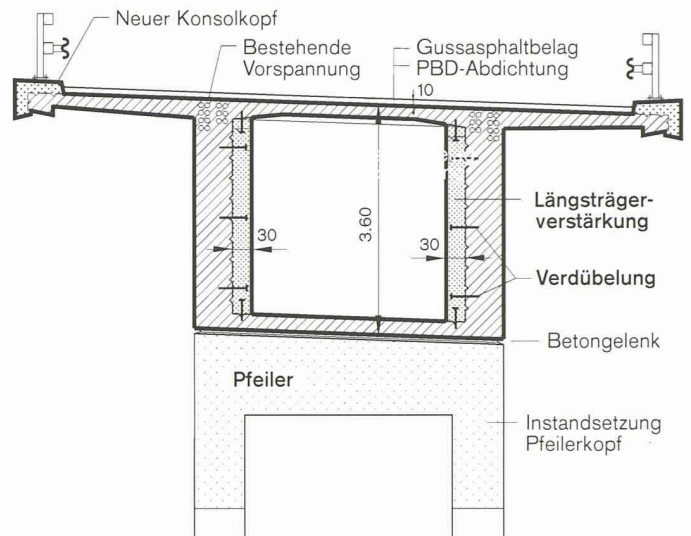
10 Längsträgerverstärkungen
