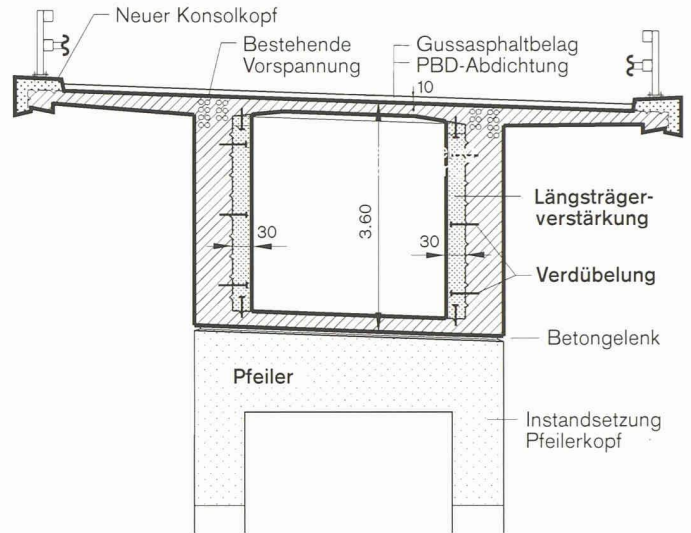
10 Längsträgerverstärkungen
