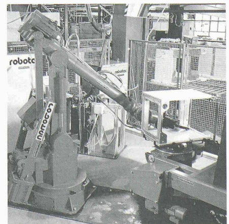
Schulthess fertigt in Wolfhausen u.a. Waschautomaten. Im Bild der Einsatz moderner Roboter in der Gehäusefertigung
