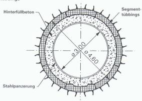
Querschnitt des geplanten gefrästen Druckschachts von Mauvoisin II (Projekt: Electrowatt Engineering 1994). Vorgefertigte Betonsegmente als Ausbruchsicherung, Stärke der Stahlpanzerung am Schachtfuss 44 mm bei max. dvn. Druck von 172 bar
