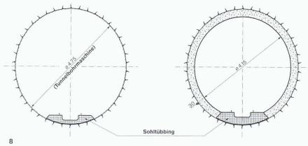
Querschnitte des geplanten gefrästen Druckstollens von Mauvoisin II (Projekt: Electrowatt Engineering 1994). Links: unverkleidete Stollenstrecke. Rechts: Betonauskleidung mit vorfabrizierten
