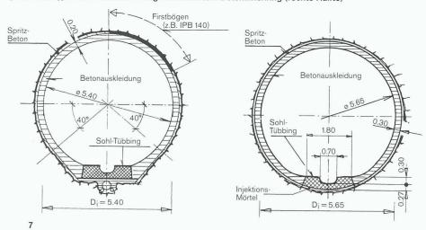
Querschnitte des Druckstollens des Walgauwerks im Vorarlberg (1984). Links: Konventioneller Ausbruch, Betonauskleidung, Vorauskleidung mit Spritzbeton und Firstbögen. Rechts: Maschineller Ausbruch, Betonauskleidung, Vorauskleidung mit Spritzbeton
