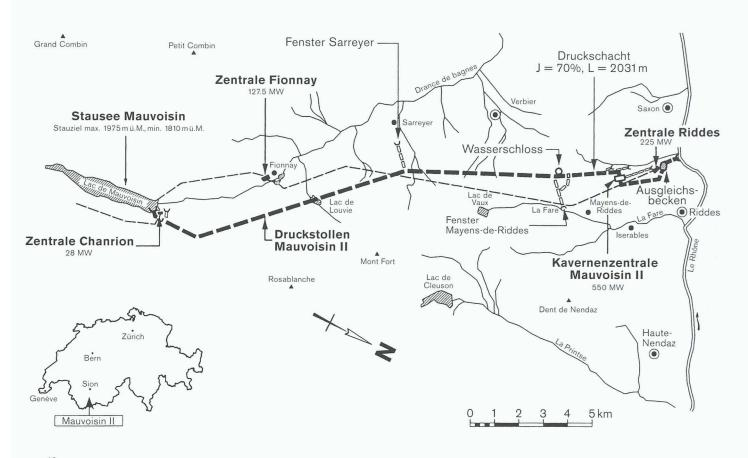
Übersicht über die bestehenden Anlagen der Kraftwerke Mauvoisin AG und der geplanten Leistungsstufe Mauvoisin II
