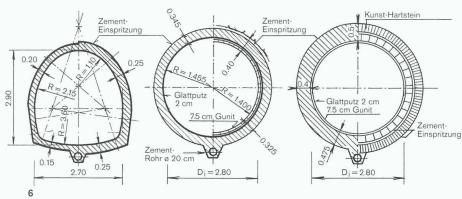
Querschnitte des ersten Druckstollens des Kraftwerks Amsteg (1924). Links: Betonauskleidung mit Glattputz. Mitte: Betonauskleidung mit Glattputz (linke Hälfte), Betonauskleidung mit armiertem Spritzbetoninnenring (rechte Hälfte). Rechts: Betonauskleidung mit armiertem Spritzbetoninnenring (linke Hälfte), Kunststeinauskleidung mit armiertem Betoninnenring (rechte Hälfte)
