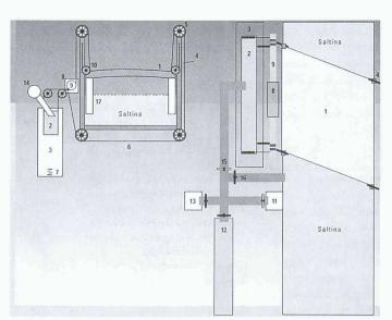
8 Hubmechanik: 1 Brückenplatte, 2 Stahltank als Gegengewicht, 3 Spannschacht, 4 Säulen, 5 Umlenkräder, 6 Stahlseil, 7 Puffer, 8 Hydraulikbremse und Rücklaufsperre, 9 Synchronisationsachse, 10 Flaschenzug, 11 Hochwasserfassung, 12 Reservoir, 13 Hydrantenanschluss, 14 Zuleitung, 15 Sicherheitsschieber, 16 Entleerungsschieber, 17 Schürze der Hubträger
