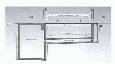
7 Längsschnitt mit den beiden Positionen
