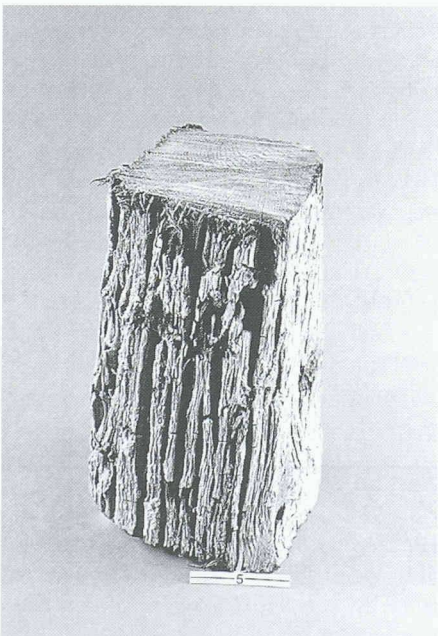
Holz aus der Verbauung nach der Trocknung, a: Fichte mit Rissbildung im Randbereich, b: Eiche mit Rissbildung
