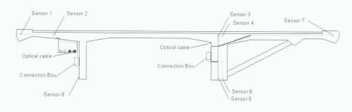
Glasfasersensoren-Setup der Versoix-Autobahnbrücke. Gegen 100 Sofo-Sensoren wurden zu einem 3D-Netzwerk versponnen, um u.a. die Durchbiegung zu ermitteln
