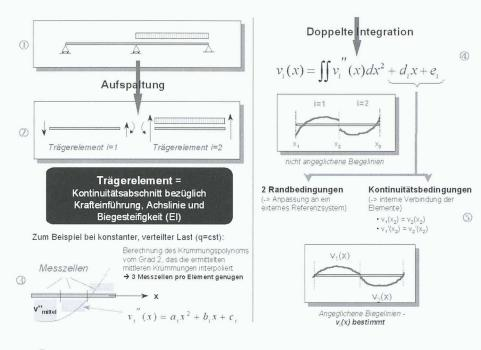
Funktionsweise des angewandten Algorithmus, mit dem die exakte Biegelinie eines Balkens anhand der mit den Glasfasersensoren gemessenen Krümmung ermittelt werden kann
