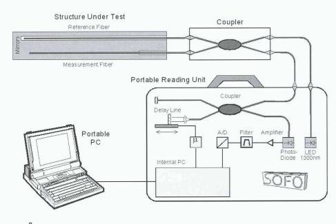
Betriebsprinzip des Interferometers in niederer Kohärenz
