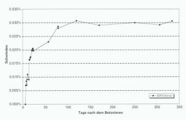
Messung des Schwindverhaltens der Platte während des ersten Jahres mittels einer 20 m langen, optischen Faser
