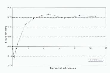
Verformungsmessung des jungen Betons der Fahrbahnplatte der Verbundbaubrücke. Die Quell- und Schwindphasen sind klar ersichtlich
