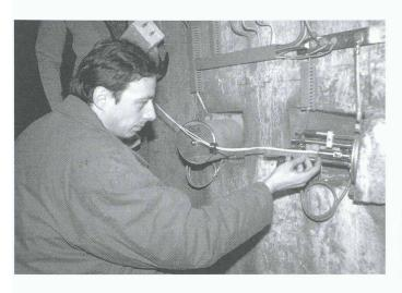
Installation eines faseroptischen, 30 m langen Extensometers in der Emosson-Staumauer
