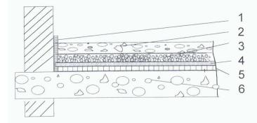
4 Wandkonstruktion, Aufbau. 1: Gipsplatten 2 x 12,5 mm, 2: Absorptionsmaterial (38 kg/m³), 3: Hohlraum, 4: Best. Wand (375 kg/m²)
