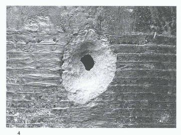
Durch einen Gleichstrom verursachter Korrosionsangriff auf eine Rohrleitung
