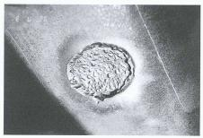
2 Durch Wechselstrom verursachter Korrosionsangriff
