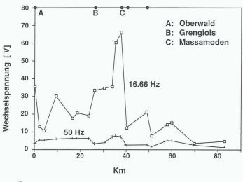
Induzierte Wechselspannung auf der Erdgasleitung Rhonetal, gemessen gegen neutrale Erde im Bereich von Oberwald bis Sierre
